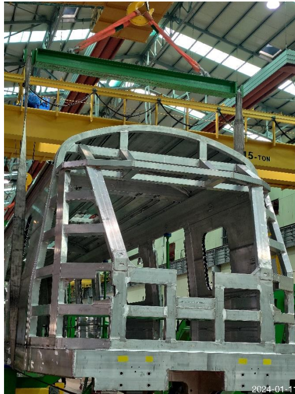
捷運綠線首列車廂於韓國昌原工廠完成焊接及組立
