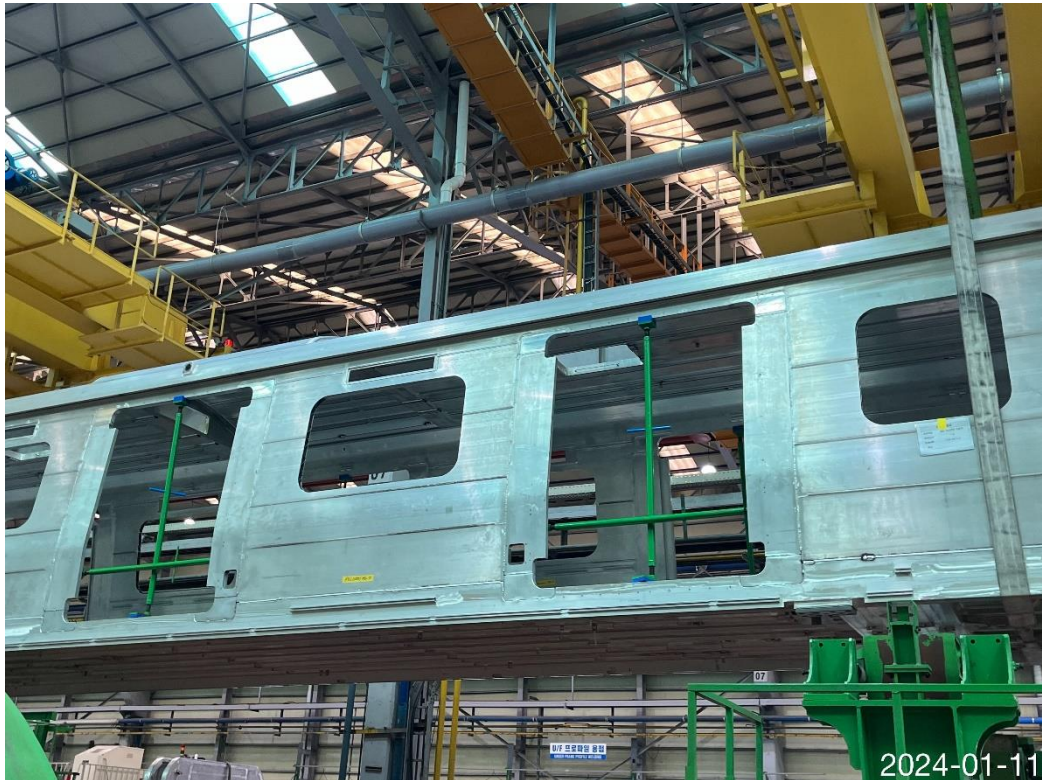
捷運綠線首列車廂於韓國昌原工廠完成焊接及組立
