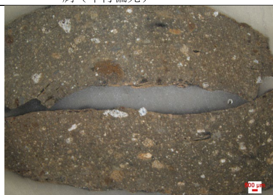
圖版167：夾沉積岩／變質岩陶片切片面顆粒分布
