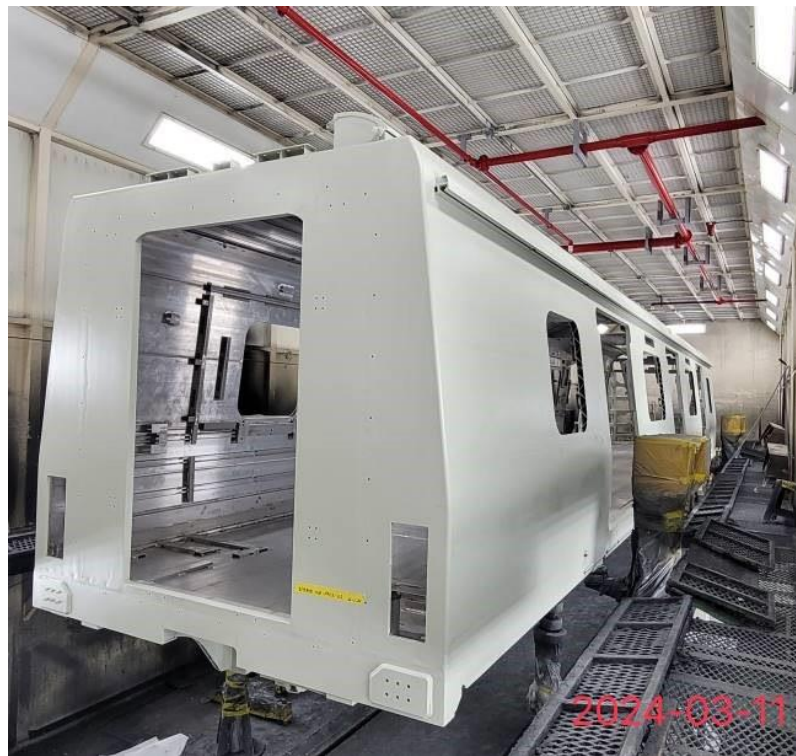
捷運綠線首列車車廂底漆工程
