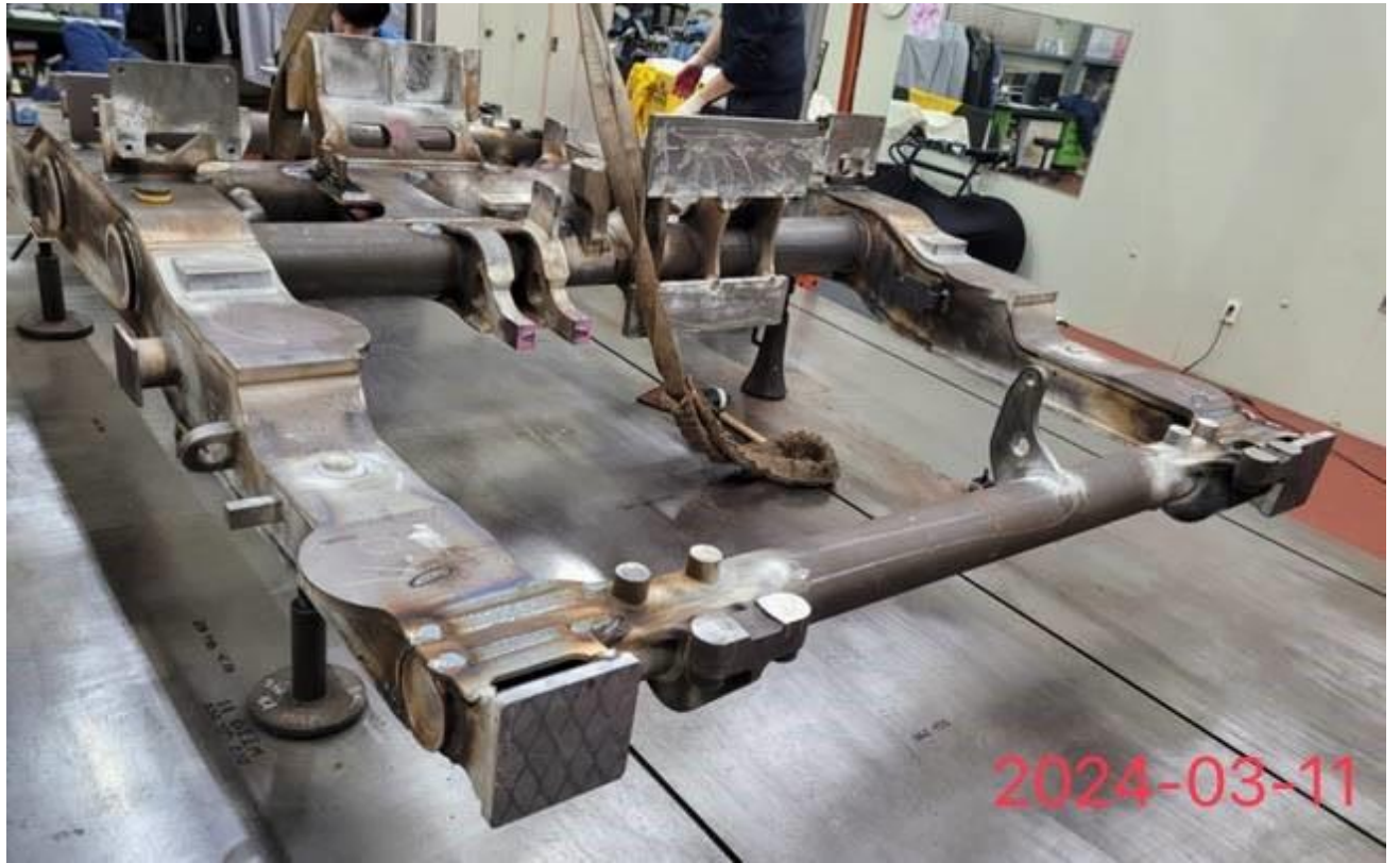
捷運綠線首列車轉向架焊接工程
